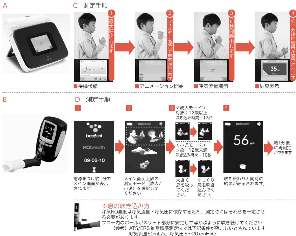
図 2 携帯型 FeNO 測定器と測定手順
